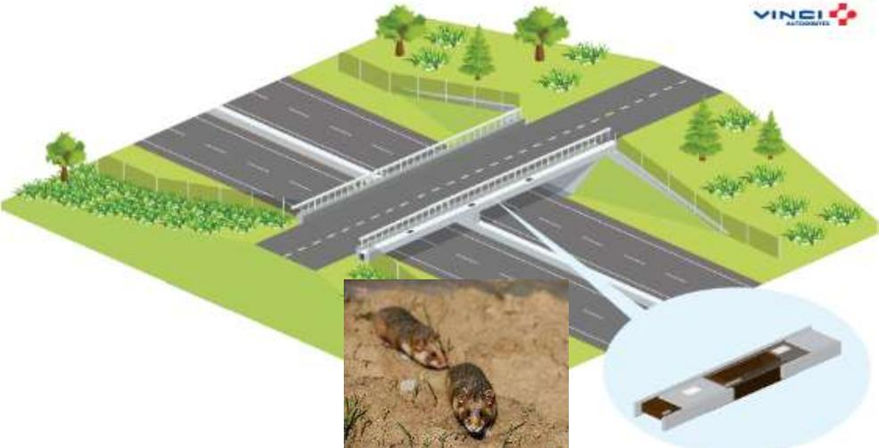
Les rampes d'accès aux bioducs, le long des remblais des passages supérieurs, sont limitées à une pente de 25 % (4/1).
